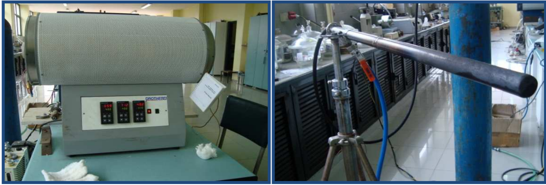
Şekil 3.4 Numunelerin ısıtılma sırasında kullanılan paslanmaz çelik tüp ve fırın
