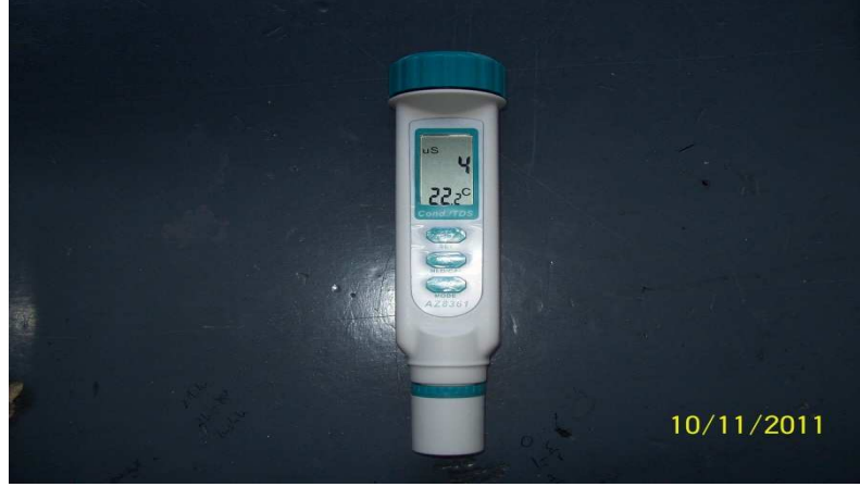
Şekil 3.4 İletkenlik ve tuzluluk ölçer (µS)
