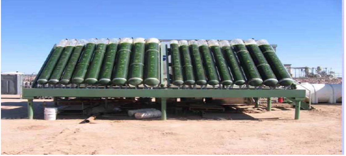
Şekil 1.21 Algepower Gmbh Manhattan ,ABD’de yeni kurulan bir fotobiyoreaktör
