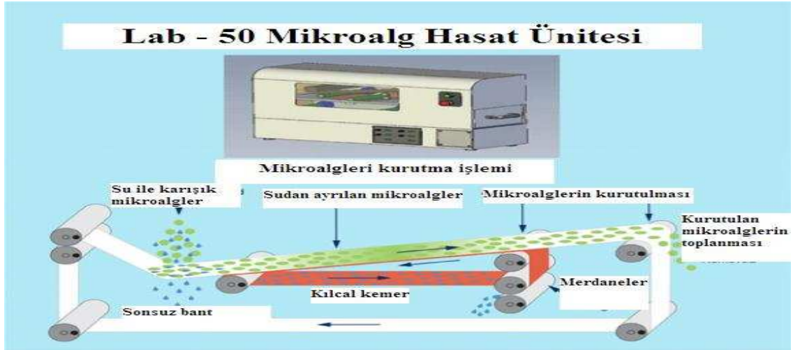
Şekil 1.29 Lab – 50 mikroalg hasat ünitesi işlem şeması
