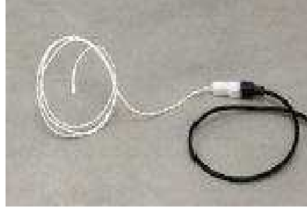
Şekil 3.4 Solunum sinyallerinin alındığı nazal termistör
