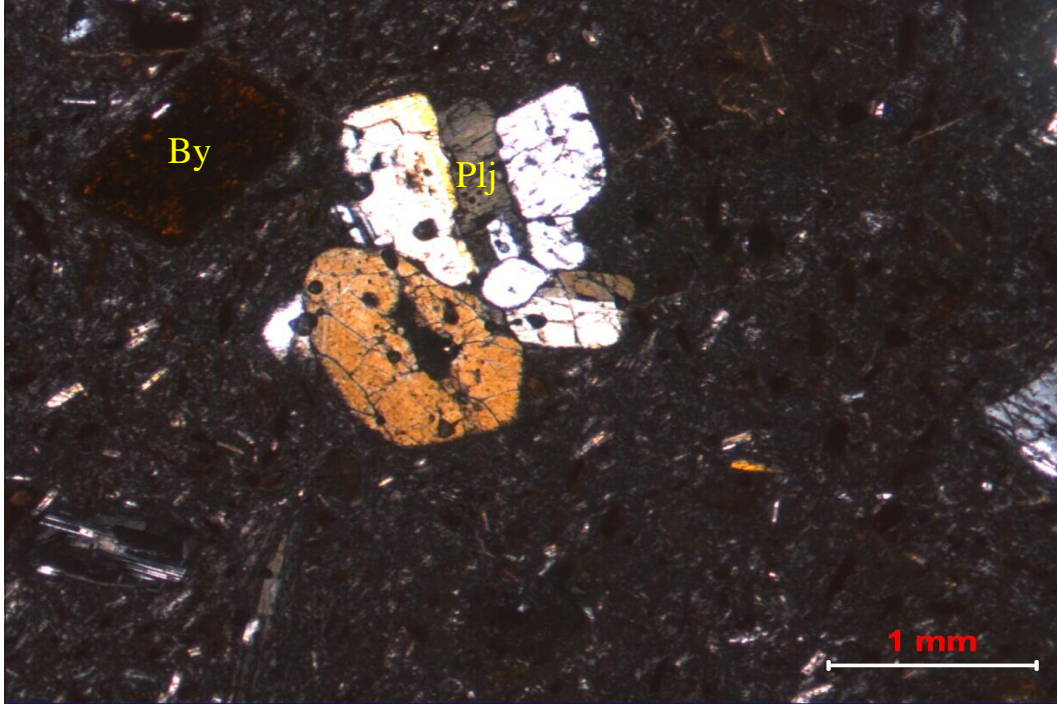
Foto 2.15 Plajiyoklas ve opasitleşmiş, opaklaşmış biyotit içeren dasitin mikrofotografı (Plj: Plajiyoklas, By: Biyotit)
