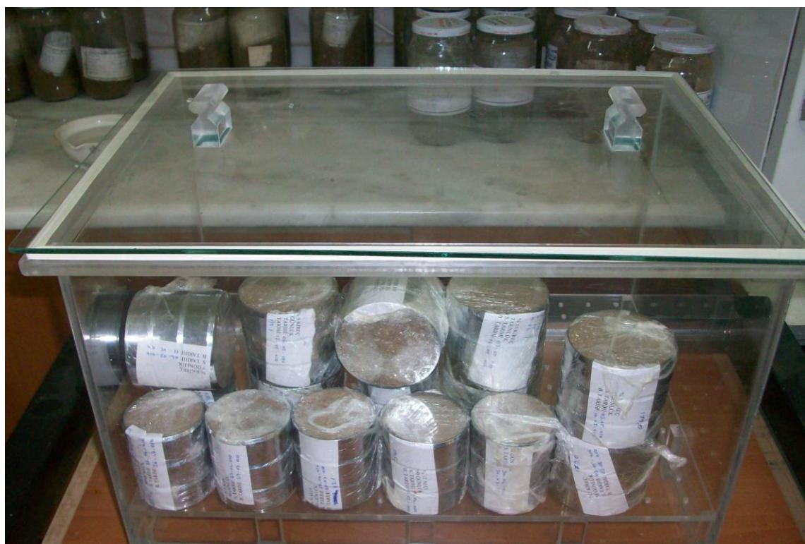
Şekil 1.3 Farklı oranlardaki kireç, jips ve kireç-jips karışımılarında şişme basıncı ve şişme yüzdesi için hazırlanan kil örnekleri
