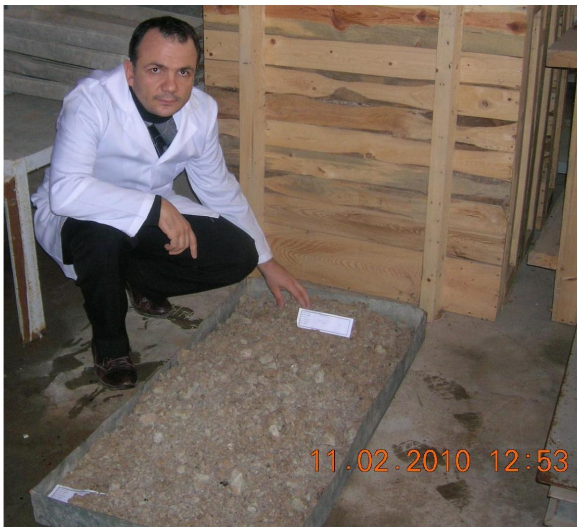
Şekil 1.4 Karışımlarda kullanılan yüksek plastisiteli kil (CH)
