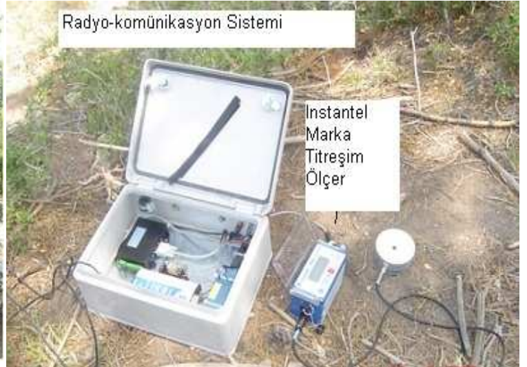
Şekil 5.7 İkinci radyo-komünikasyon Sistemi ve Instantel Marka Titreşim Ölçer Cihazı
