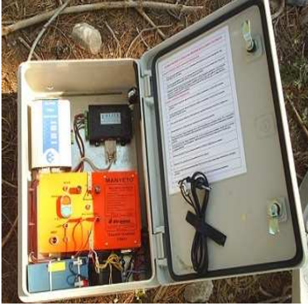
Şekil 5.6 Manyeto ve birinci radyo-komünikasyon cihazı
