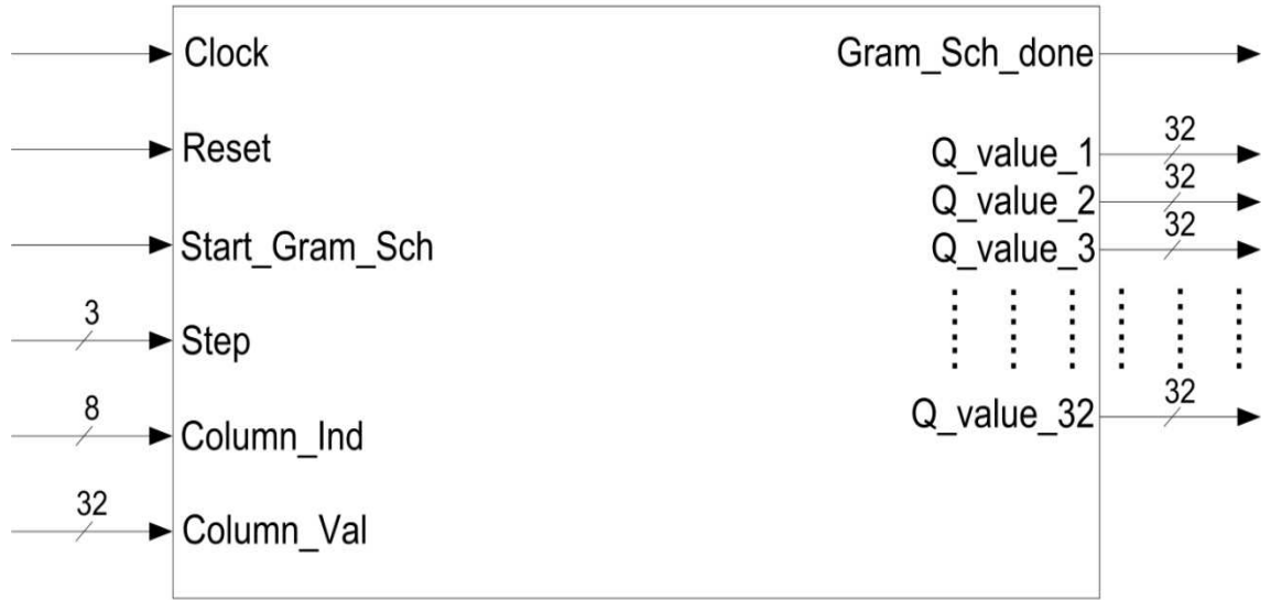
Şekil 3.10 Modified Gram Schmidt modülü blok diyagramı
