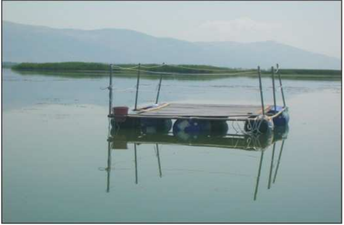
Şekil 1.3 Gölden karot alımı için hazırlanan platform
