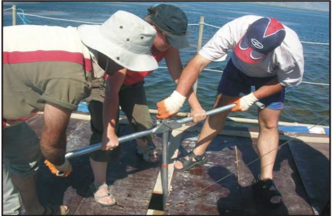
Şekil 1.4 Livingstone corer ile örnek alma işlemi
