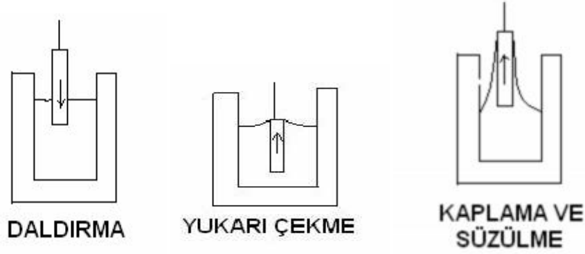
Şekil 3.2 Film oluşum aşamalarının şematik gösterimi (Tıǧlı 2000).
