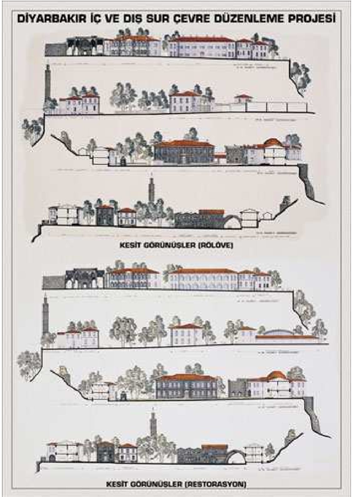
Şekil 5.8 İçkale koruma projesi kesit ve görünüşler ( www.mimdap.org 2007))
