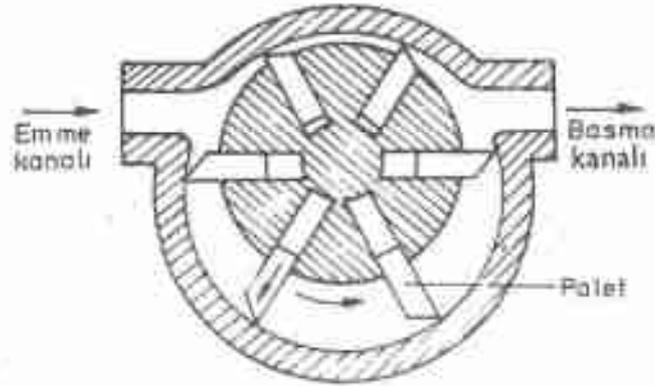
Şekil 4.19. Paletli pompa.
