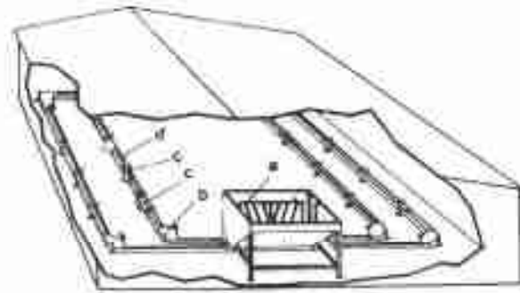
Şekil 33. Bantlı otomatik yemliğin şematik montaj resmi (a: depo, b: yem dağıtıcı düzeni, c: yem taşıyıcı, d: bant).
