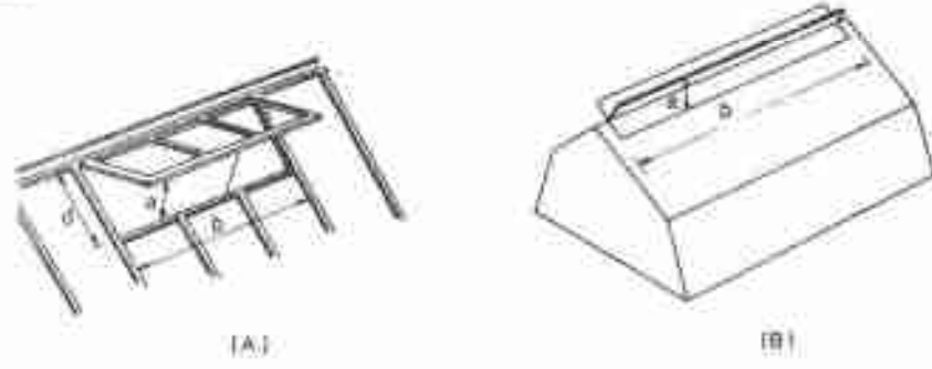
Şekil 18. Doğal havalandırma için kullanılan çatı pencereleri.
