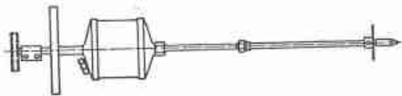
Şekil 8.4. Elle kullanılan toprak enjektoru.
