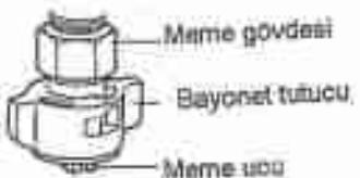
Şekil 4.52. Bayonet tutucuya sahip yanaklı tip membe.
