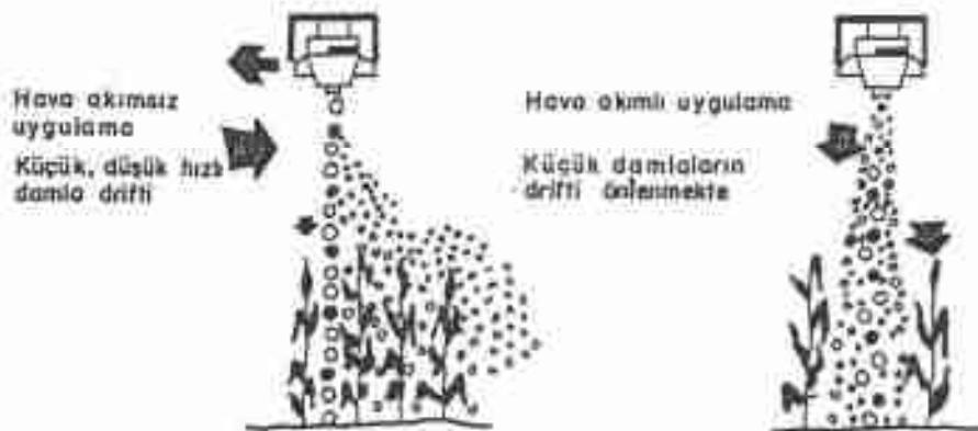
Şekil 4.112. Hava akımının damlayı hedefe yönetme ve sürükleme etkisi (drift) azaltma etkisi.
