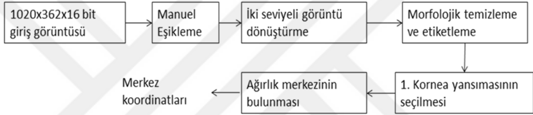
Şekil 3.33 Kornea yansıması merkezinin belirlenmesi
