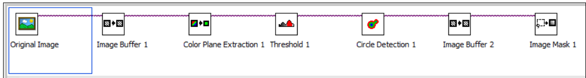
Şekil 3.41 Yansıma için vision assistant kodu (uygulama 2)
