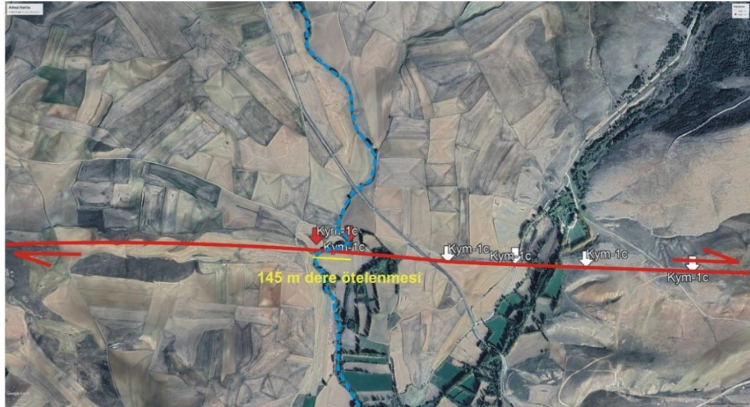
Şekil 4.77 Kym-1c segmentinin yarattığı 145 m sağ yanal dere ötelenmesi. Konum için 4.75'e bakınız
