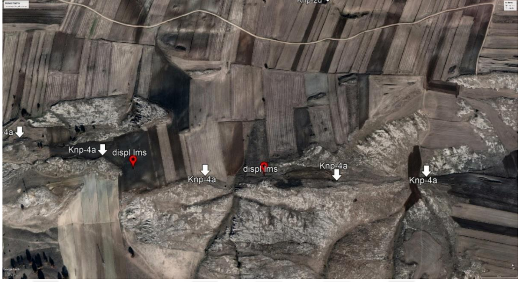
Şekil 4.38 Kireçtaşı bloğundaki tahmini 300 m lik sağ yanal yerdeğiştirme. Kırmızı simgeler kireçtaşı bloklarının ötelenmesini göstermektedir. Konum için 4.36'a bakınız
