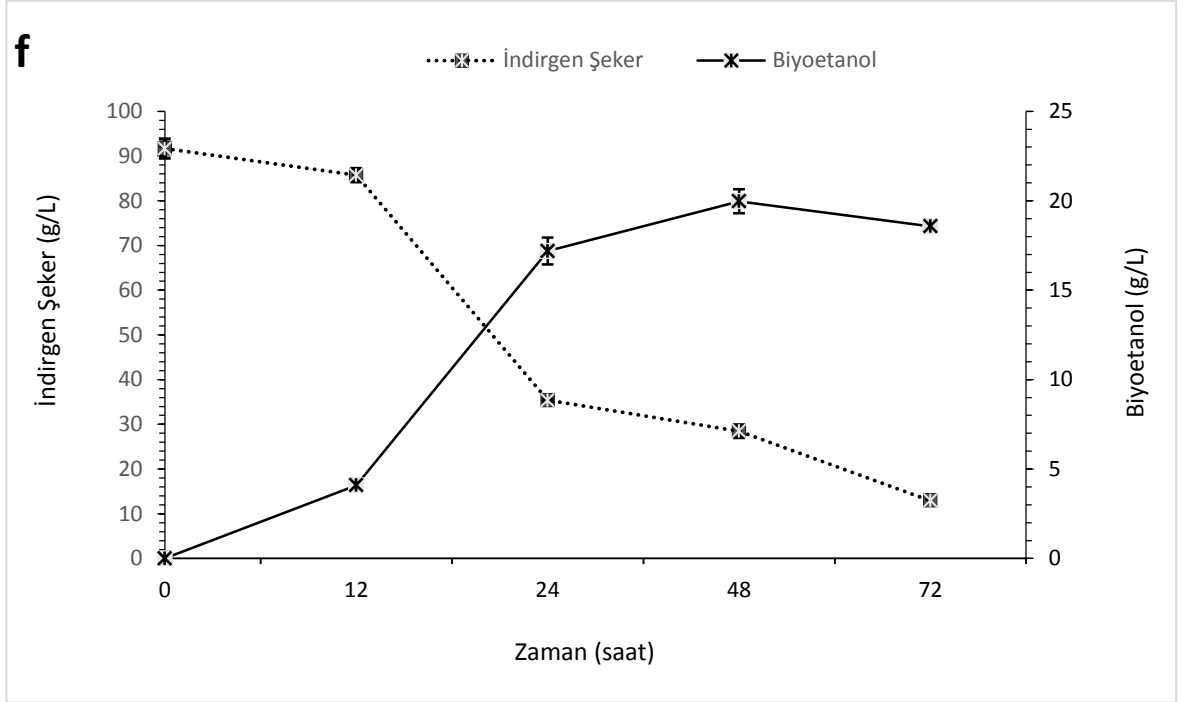
Şekil 4.2 Enzimatik hidrolizin etanol üretimine ve indirgen şeker konsantrasyonuna etkisi (devam)(Ön işlem koşulları: 1% H 2 SO 4 , 121°C, 15 dk otoklavlama, 15 FPU selülaz, 15 U/mL hemiselülaz fermentasyon koşulu: pH 5, T 30 °C, Çalkalama Hızı: 100 rpm) a) S. cerevisiae b) P.stipitis c) C. boidinii -1 d) C. boidinii -2 e) C.boidinii -3 f) C.boidinii -4 (devam)
