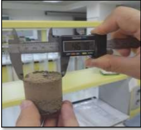
Şekil 3.10 Kumpas ile çap ölçümü
