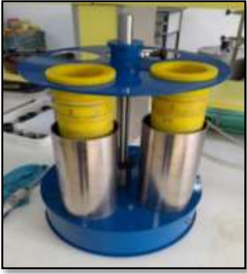
Şekil 3.6 Çoklu elek yöntemi ıslak eleme cihazı
