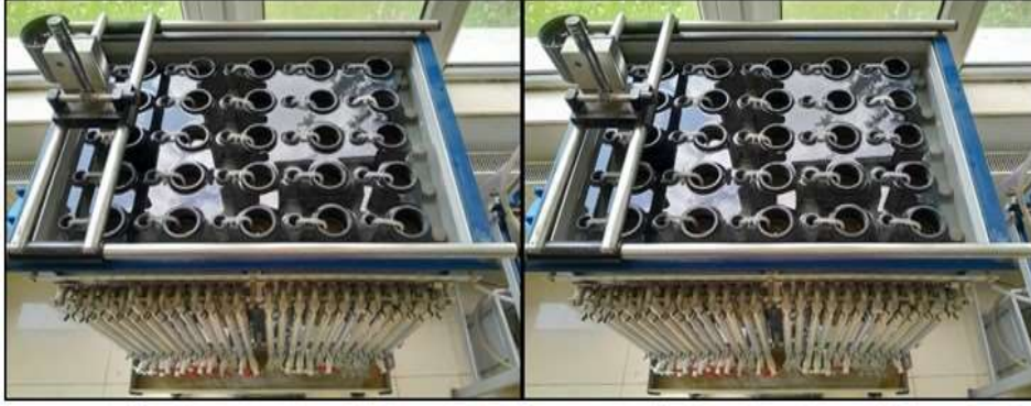
Şekil 3.4 Araştırmada kullanılan hidrolik iletkenlik cihazları
