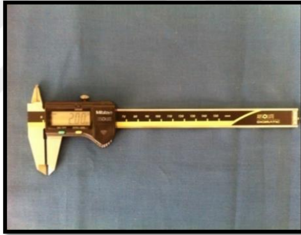
Şekil 2.8. Digital Kumpası (Mitutoyo, CD-15CPX, Japan)
