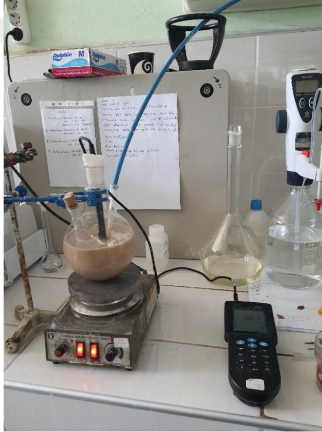
Şekil 3.1 Tez çalışmasında kullanılan karbonatlama çamurunun EDTA ile saflaştırma sistemi
