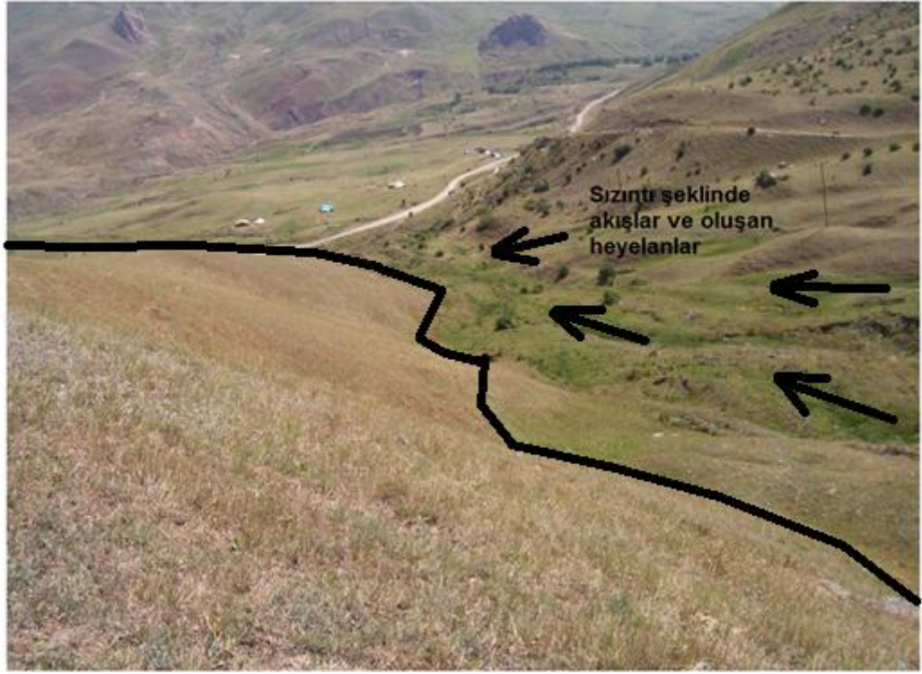
Şekil 3.17 Çalışma alanında heyelanlara neden olan etkilere birisi olan sızıntı akışının yüzeydeki yansıması ve neden olduğu heyelanlar (Oklar akış yönünde)
