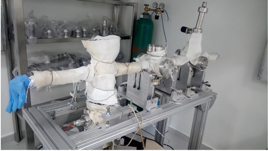
Şekil 4.15 Gaz giderme için sistem üzerinde kullanılan gaz giderme battaniyesi ve kabloları
