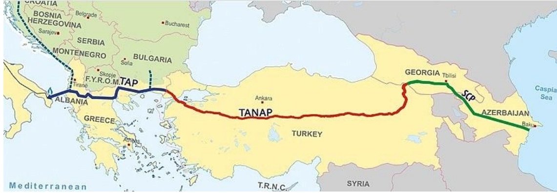
Şekil 23: TANAP Doğal Gaz Boru Hattı
