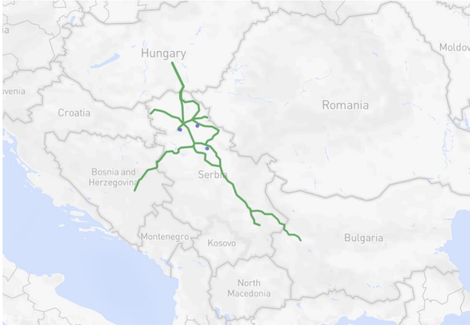
Şekil 21: Sırbistan doğal gaz boru hatları
