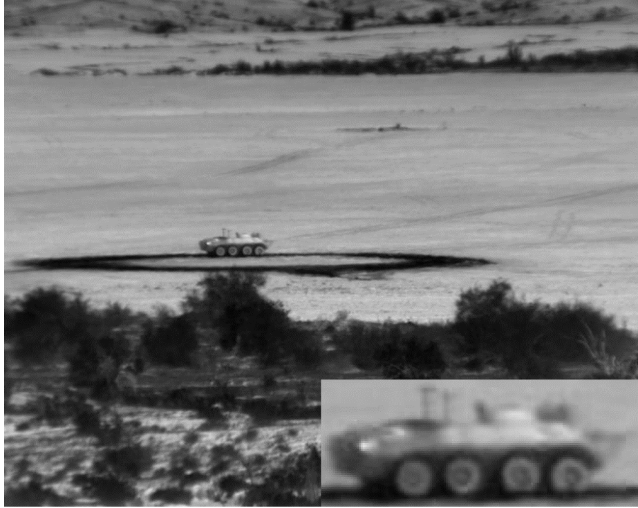
Şekil 4.7 Bikübik interpolasyon ile yukarı örneklenmiş görüntü (1280x1024)
