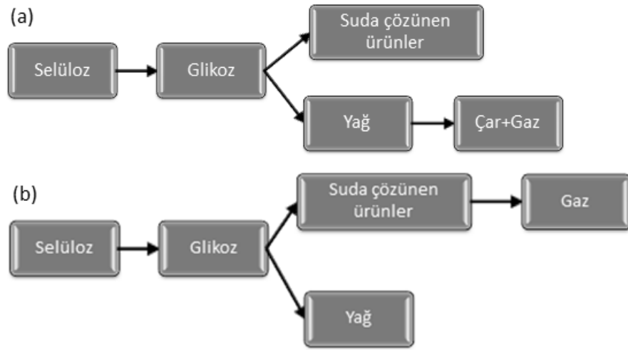
Şekil 2. 6 Selülozun parçalanmasına \text{Na}_2\text{CO}_3 'ün etkisi
