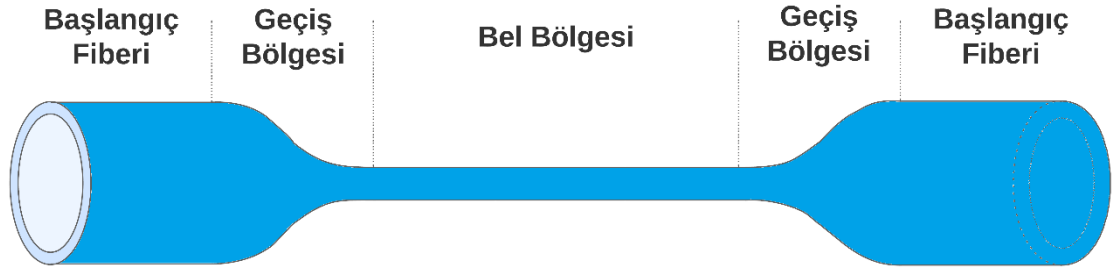
Şekil 3.2 Konik fiber sensörün geometrik yapısı (Şerbetçi vd. 2022a)
