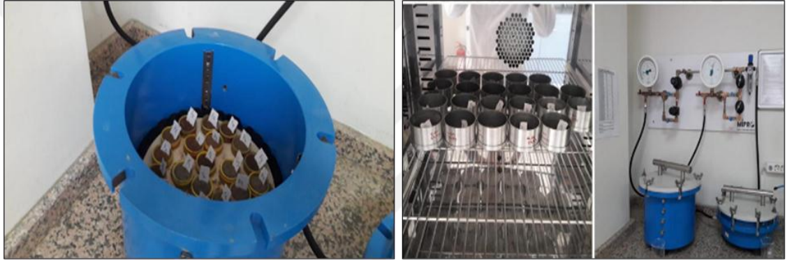
Şekil 3.2 Tarla kapasitesi ve solma noktası ve hacim ağırlığının belirlenmesi için kullanılan sistemler
