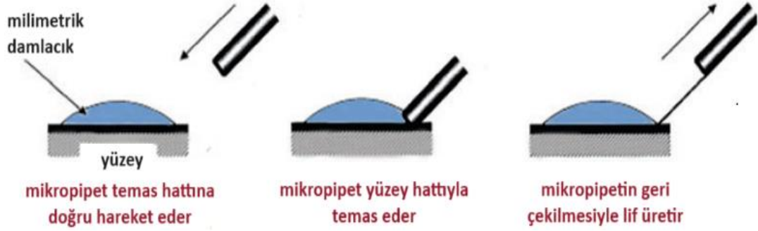
Şekil 2.50 Daha önce biriktirilmiş bir polimer çözeltisi damlasını keskin bir uçla temas ettirerek ve onu sıvı bir elyaf olarak çizerek nano-lifler üreten yöntem
