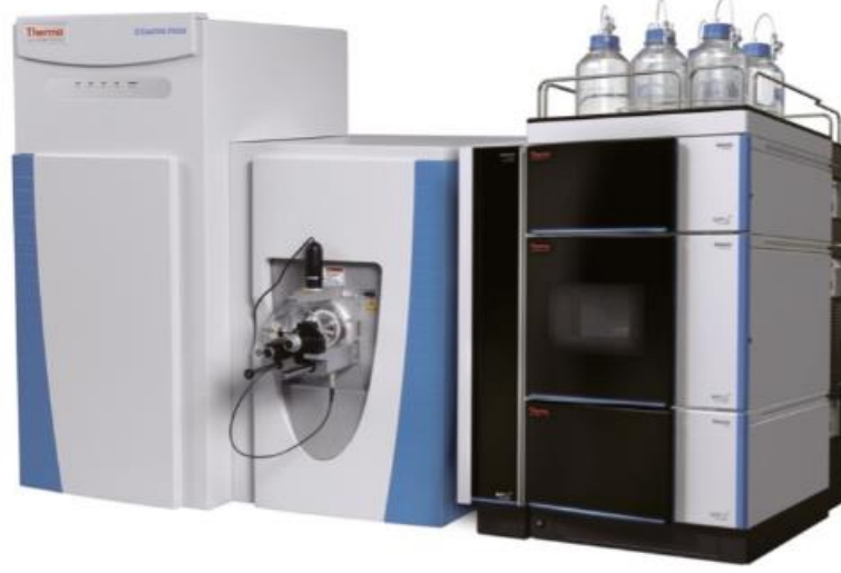
Şekil 3.8 Metabolomiks ve lipidomiks çalışmaları için kullanılan Q-Exactive Orbitrap cihazının genel görüntüsü
