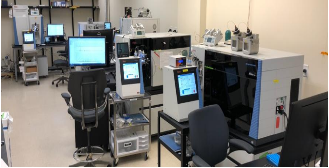
Şekil 3.6 Proteomiks çalışmaları kapsamında kullanılan Q-Exactive Plus High-Resolution Quadrupole-Orbitrap cihazı genel görüntüsü
