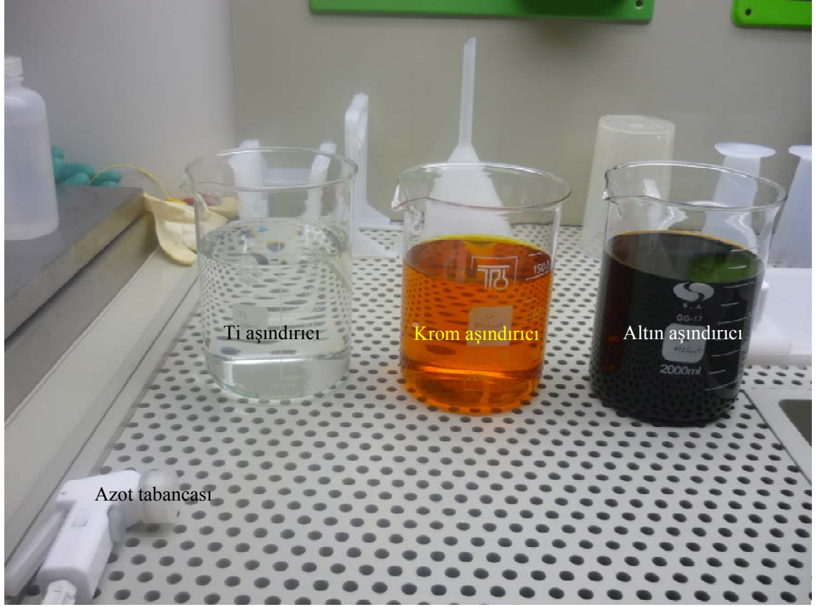
Şekil 3.2 Islak aşındırma sürecinde kullanılan aşındırıcılar ve tezgah
