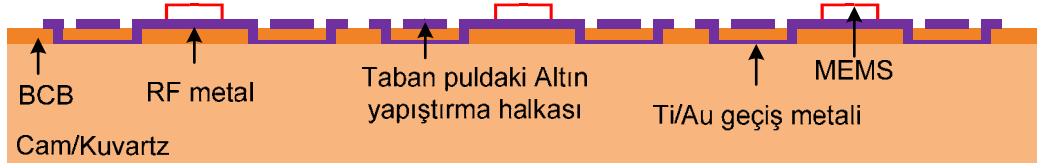
(d) ODTÜ RF MEMS standart üretim adımlarının takip edilerek RF MEMS yapıların oluşturulması
