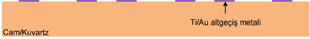
(a) Altgeçiş metalinin serilmesi ve şekillendirilmesi
