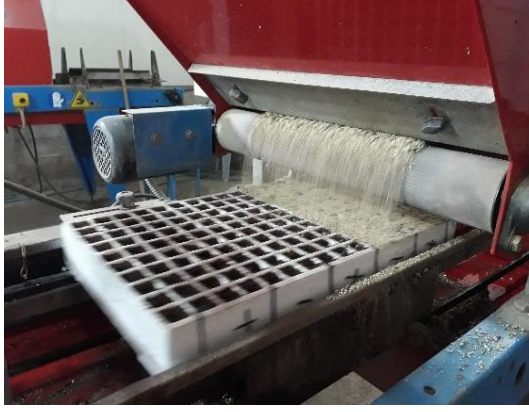
Şekil 3.27 Tohum ekimi sonrası zeolitle kapak yapılması
