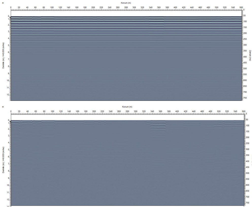
Şekil 4.23 Mogan Gölü 29 nolu radar profilinde elde edilen a. ham, b. işlenmiş radargram
