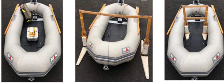
Şekil 3.2 Yer radarı yönteminin suda veri toplama tekniği (Ruffell ve Parker, 2021)
