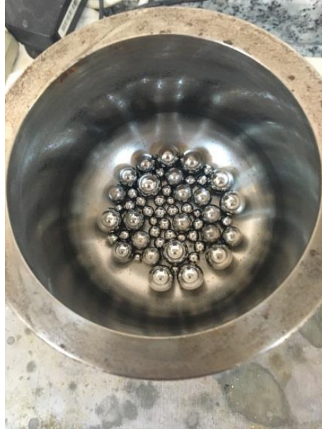
Şekil 3.6 Gezegen öğütücü reaktörü ve bilyeleri
