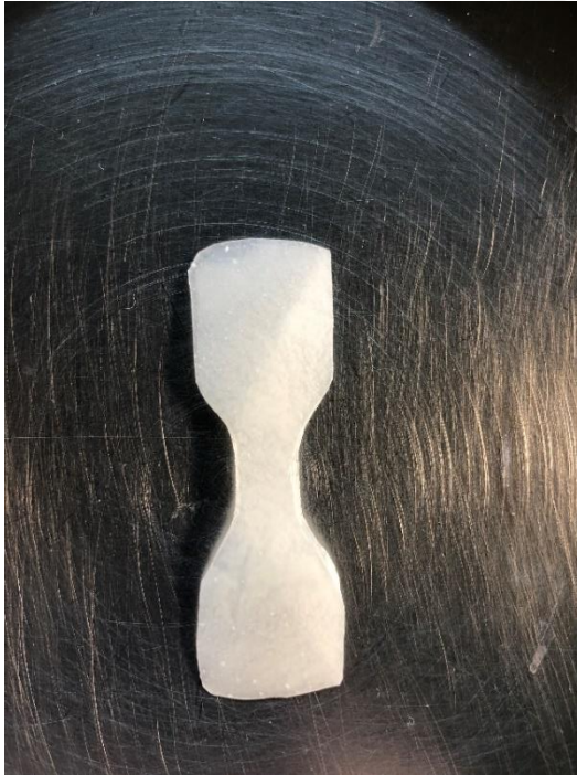
Şekil 4.18 Çekme testi numuneleri
