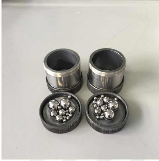
Şekil 3.4 Spex öğütücü reaktörleri ve bilyeleri
