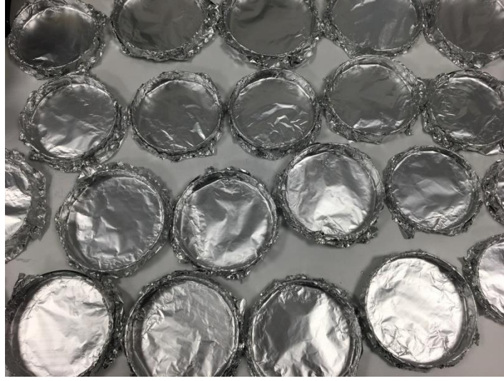
Şekil 3.9 Filmlerin çözelti dökme yöntemiyle hazırlanması
