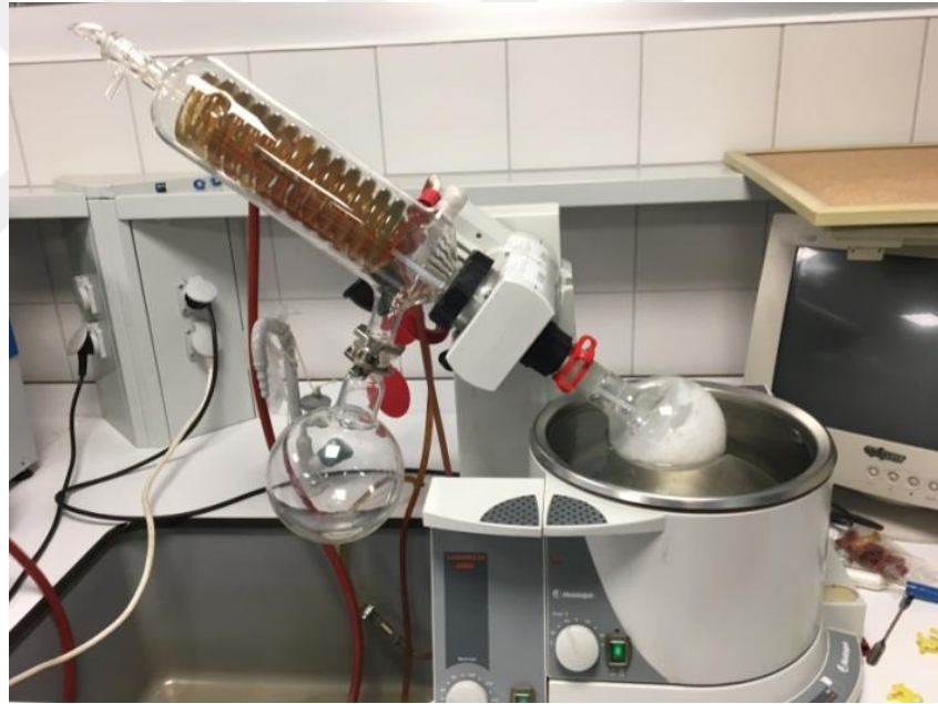
Şekil 3.13 Vakumlu döner buharlaştırıcıda çözücünün uzaklaştırılması
