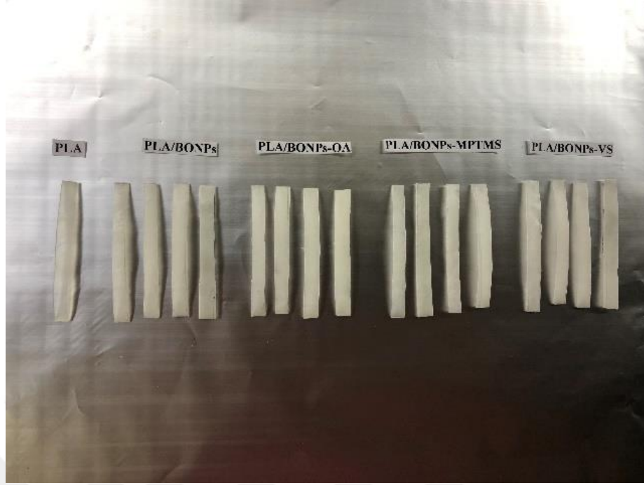
Şekil 4.29 LOI analizi için hazırlanan numuneler
