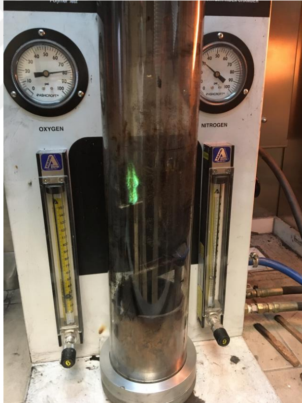
Şekil 4.28 LOI (Limit Oksijen İndeksi) cihazı
