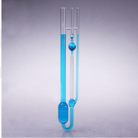
Şekil 3.18 Ubbelohde Kapiler Viskozimetresi
