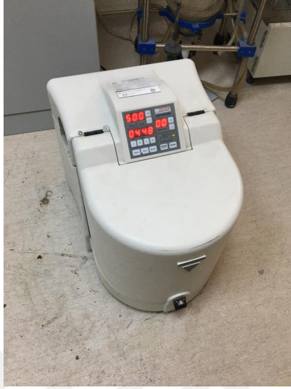
Şekil 3.5 Fritsch Pulverisette 6 Gezegen öğütücü
