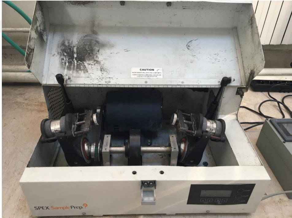
Şekil 3.3 SPEX 8000 Mixer/Mill bilyeli öğütücü
