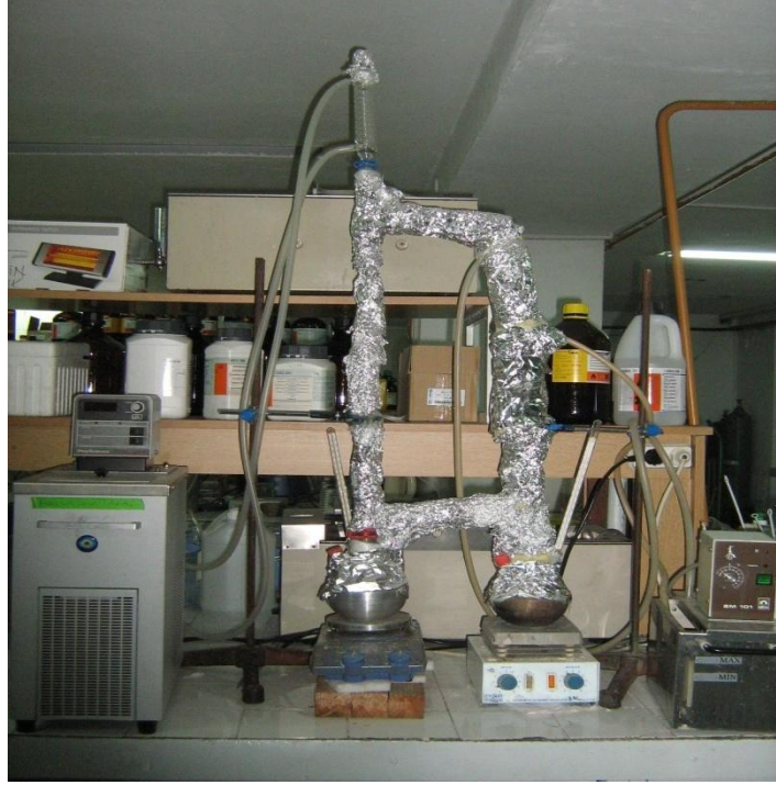
Şekil 4.5 Reaktif distilasyon deneylerinin gerçekleştirildiği sistem
