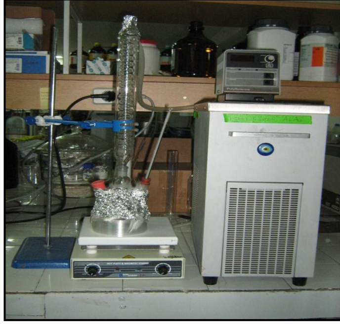
Şekil 4.3 Esterleşme deneyinin gerçekleştirildiği sistem
