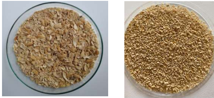
Şekil 3.1 Öğütülmüş Antep fıstığı iç kabuğu örnekleri (partikül büyüklükleri sırasıyla: ~2.5 mm ve ~500 µm)
