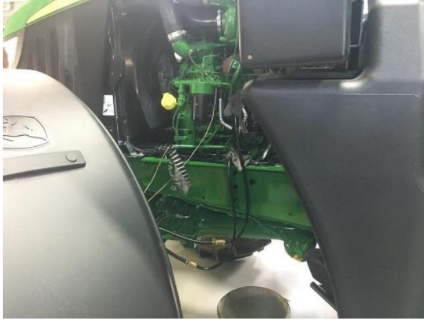
Şekil 3.23 Yakıt ölçüm sistemi bağlantısı (a), egzoz tahliye sistemi bağlantısı (b)
