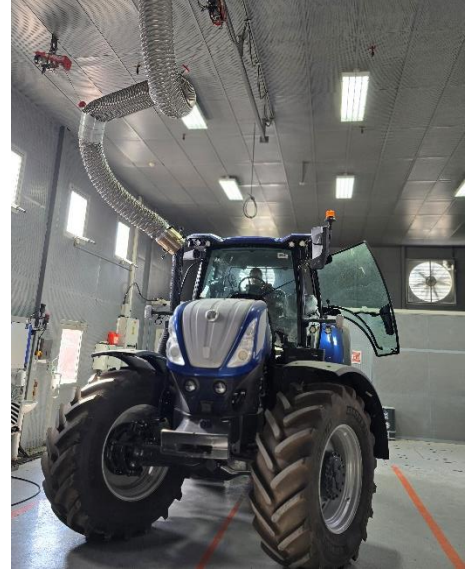
Şekil 3.23 Yakıt ölçüm sistemi bağlantısı (a), egzoz tahliye sistemi bağlantısı (b)
