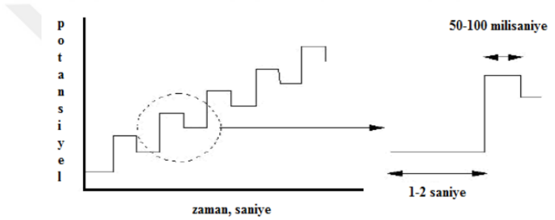
Şekil 2.7 DPV yönteminde, uygulanan potansiyelin zamanla değişimi
