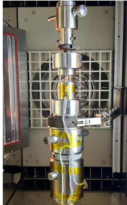
Şekil 3.4 (a) Mekanokalik deneyler için kullanılan özel tek eksenli yük sıkıştırma cihazının şematik gösterimi (b) deney düzeneğinin fotoğrafı
