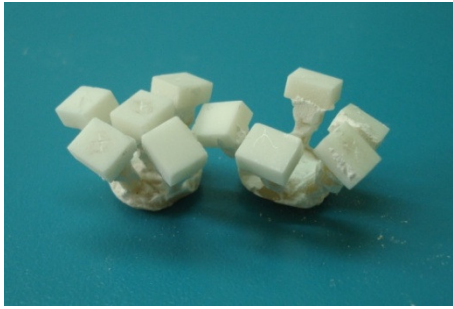
Şekil 2.29 Al 2 O 3 ile kumlanmadan önce
