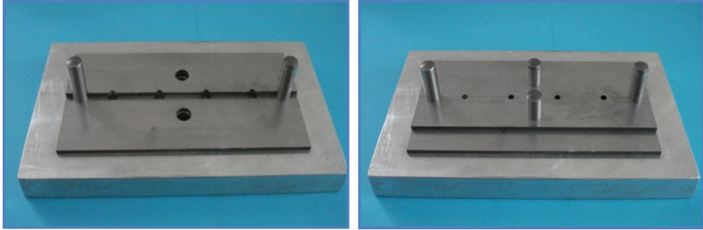
Şekil 2.12 Metal kalıbın üst tabakasının yerleştirilmesi
