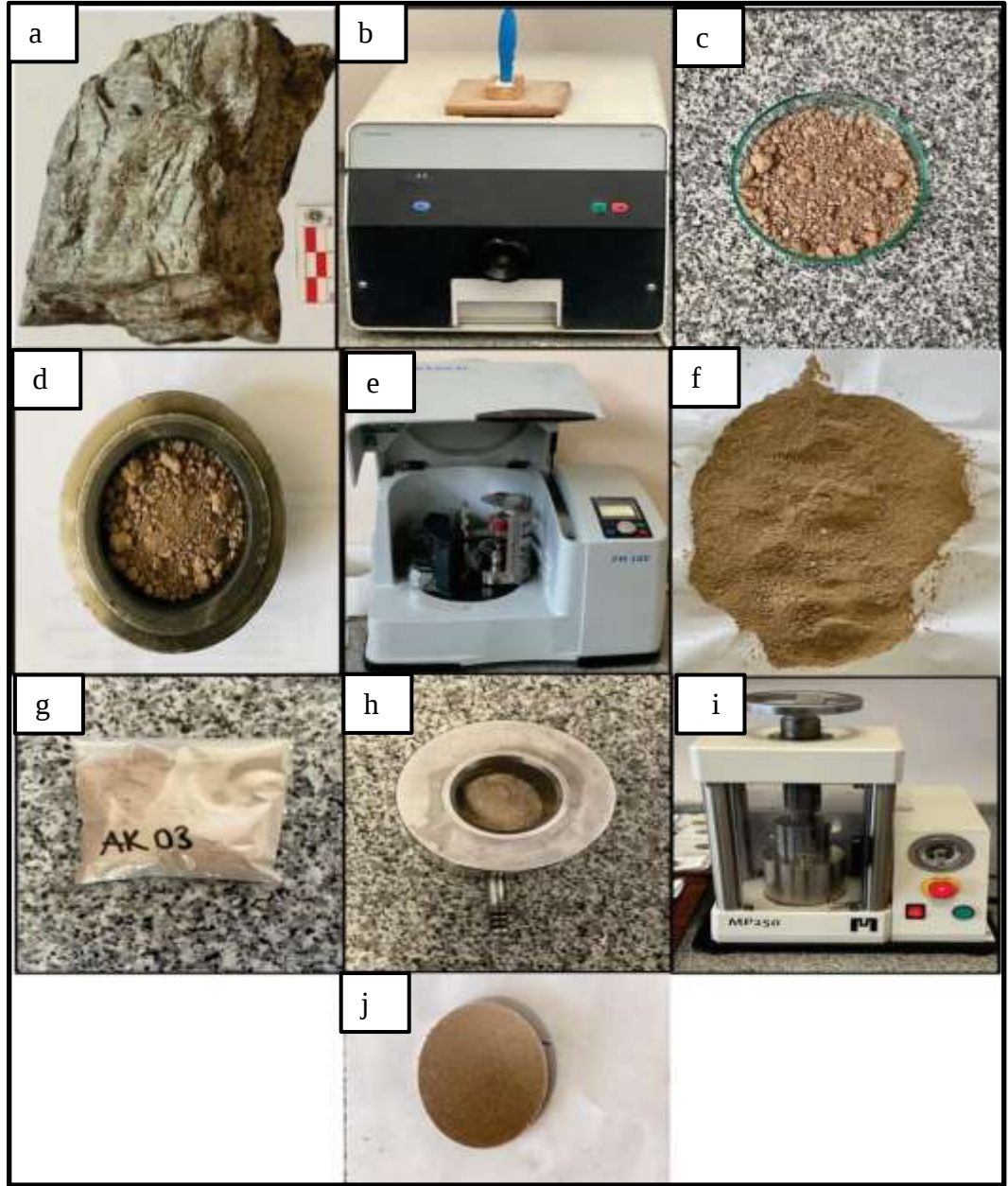
Şekil 1.2 Jeokimyasal analize tabi tutulan numunelerin işleme sırası
