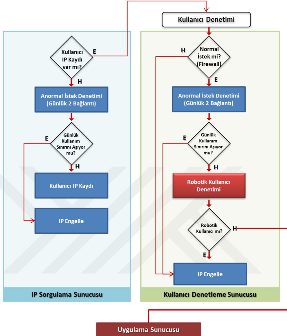
Şekil 4.3. DoS/DDoS saldırılarına karşı önerilen sunucu mimarisi
