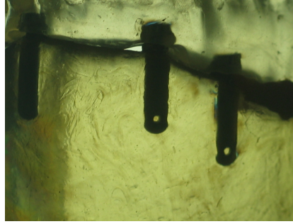
Şekil 3-20 Yük uygulandığı durumda karşı taraftaki stres dağılımı -ERA
