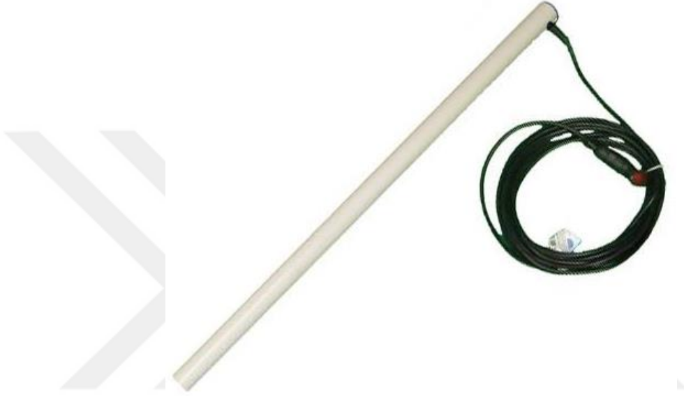
Şekil 3.7 Deneme süresince toprak nem takibinin yapıldığı toprak nem sensörleri
