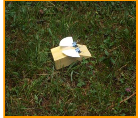
Şekil 3.13 Toprağa olan sürüklenme kayıplarının belirlenmesinde kullanılan örnekleme yöntemi
