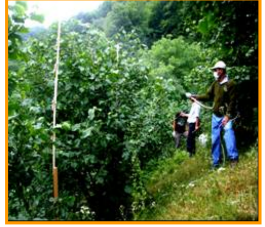
Şekil 3.12 Havaya olan sürüklenme kayıplarının belirlenmesinde kullanılan örnekleme yöntemi
