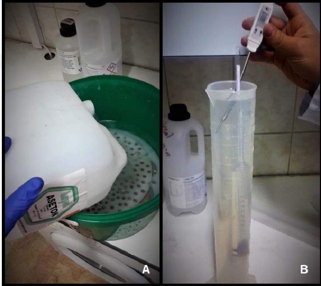
Şekil 2.4. Örneklerin 1. aseton banyosuna alınması(A), Asetonun konsantrasyon değişiminin asetonometre ile ölçülmesi (B)
