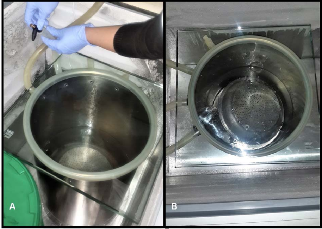
Şekil 2.5. Vakum takınına kontrol valfinin yerleştirilmesi (A), İmpregnasyonda aseton çıkışının kabarcıklarla gözlenmesi (B)
