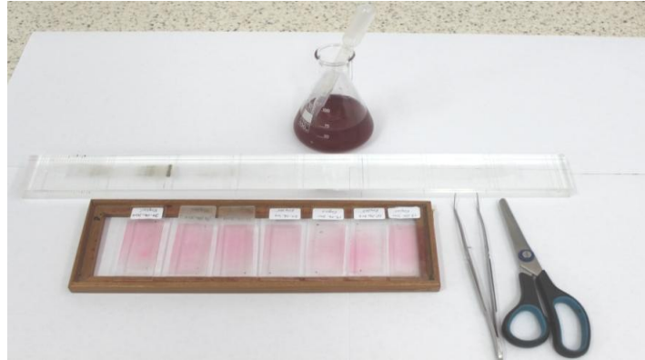
Şekil 3.13 Burkard aletinden alınan banttın 7 günlük preparatların hazırlanması
