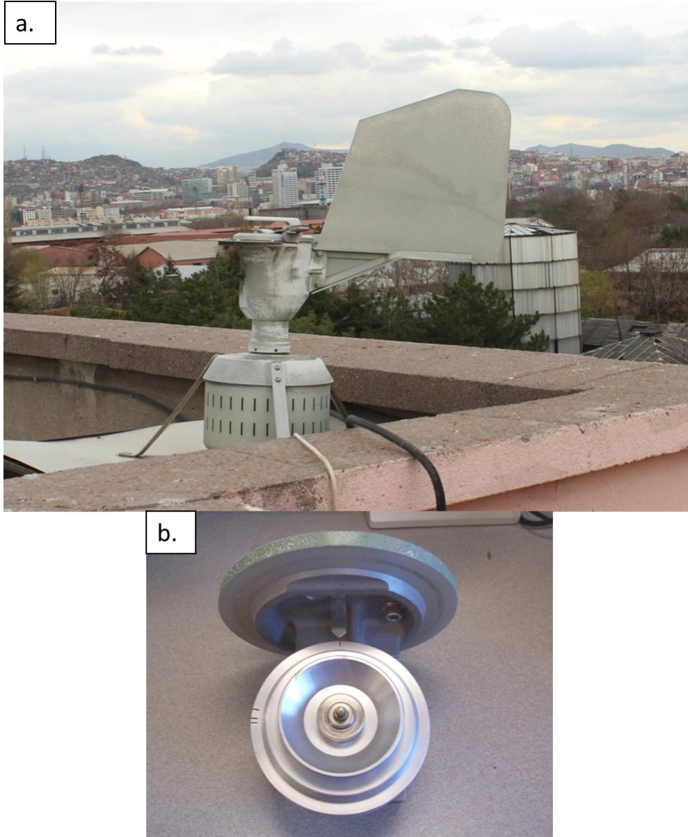
Şekil 3.12 Burkard polen ve spor tuzağı (a) ve şeffaf bandın sarıldığı döner disk (b)
