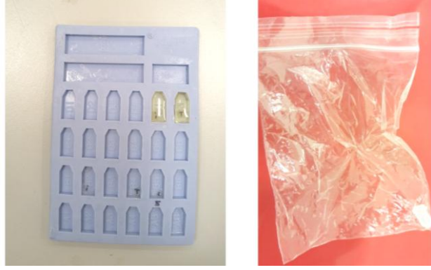
Şekil 3.20 Epoksi resine gömülen polen örneği ve vakum altına alınarak oksijeni uzaklaştırılmaya çalışılan polen örneği
