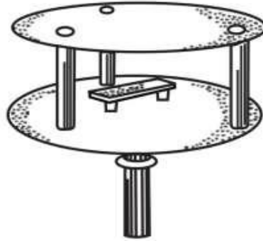
Şekil 2.2 Durham cihazının şematik şekli (Agashe ve Caulton 2009)
