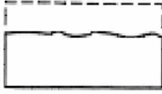
Şekil 2.1 Genel Korozyon (Gedikli, 2004)
