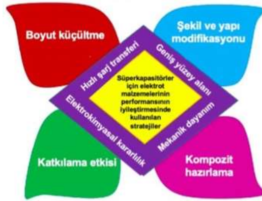
Şekil 2.15 Yüksek enerjili süperkapasitörler için elektrot malzemelerinin performansını artırmak için geliştirilmiş yöntemler (Majumdar 2021)
