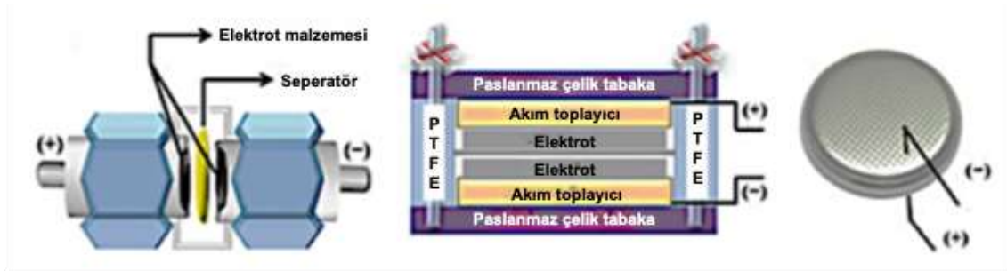
Şekil 2.5 Süperkapasitör performansının testinde kullanılan çeşitli iki elektrotlu sistemler (Ratha ve Samantara 2018)
