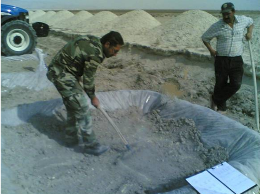
Şekil 3.11 İslah maddesinin toprağın ilk 10 cm'sine karıştırılarak tırmıkla tesviye edilmesi
