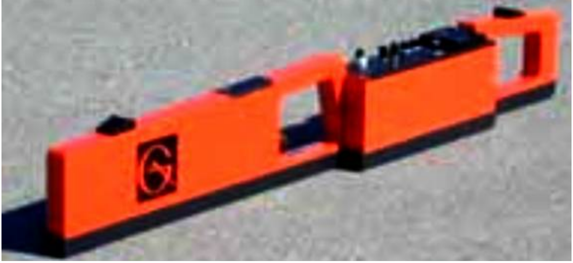
Şekil 3.4 Toprak tuzluluğunun belirlenmesinde kullanılan EM38 aleti
