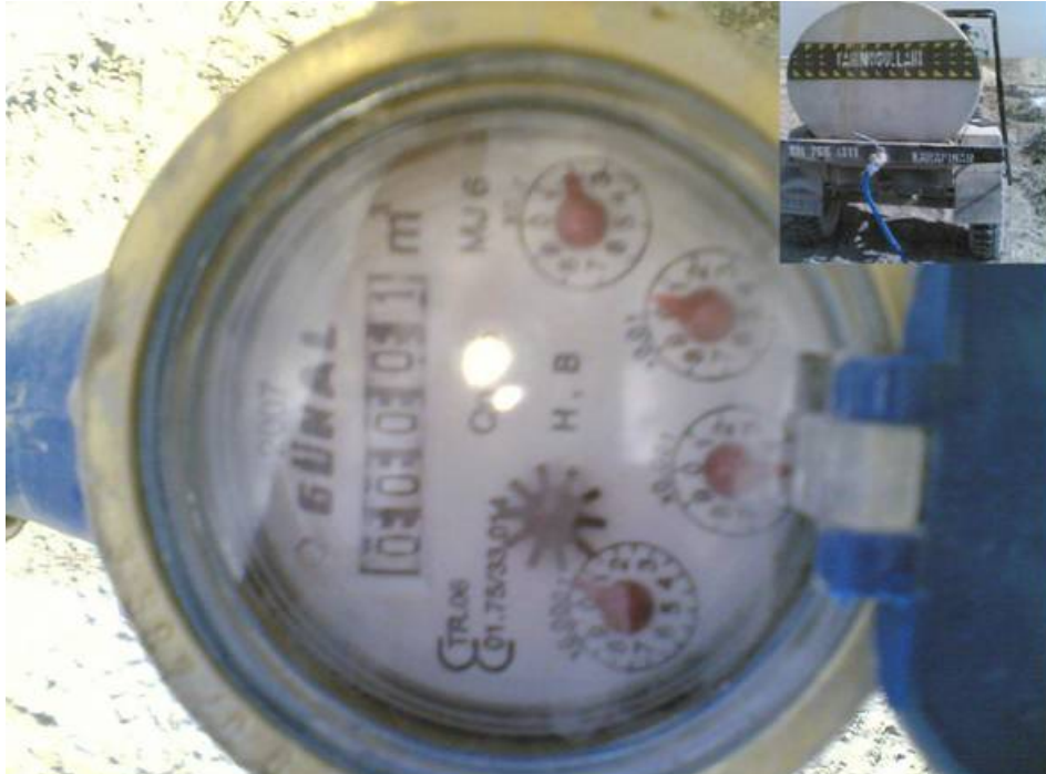
Şekil 3.12 Yıkama suyunun ölçümünde kullanılan su sayacı
