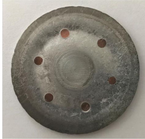
Şekil 4.1 Katkılı FePt üretiminde kullanılan hedef
