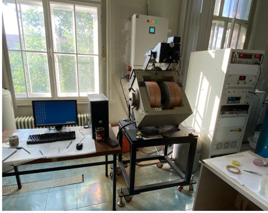
Şekil 3.8 Titreşimli örnek manyetometresi (VSM)
