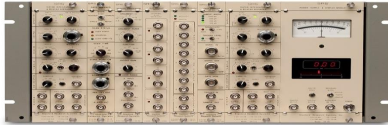
Şekil 3.26 SR280 kasaına entegre SR250 modüllü Boxcar
