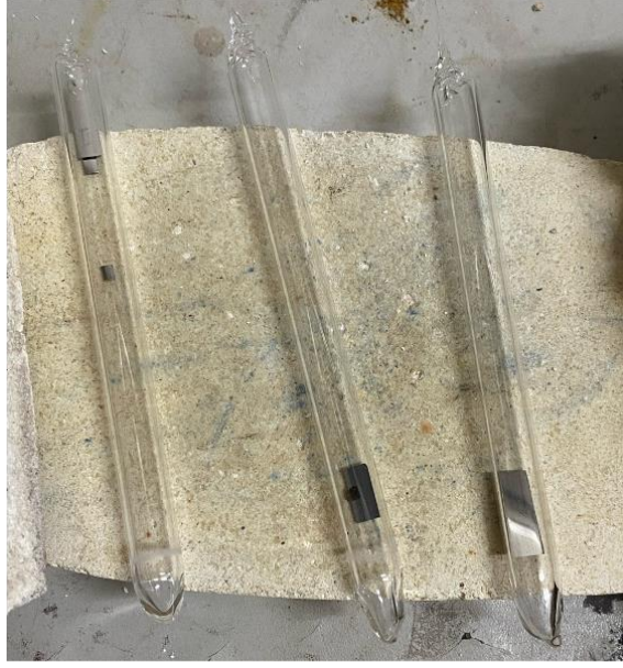
Şekil 3.3 Kuartz tüpe hapsedilmiş örnekler
