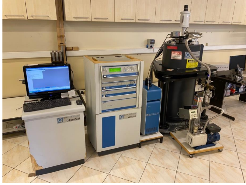
Şekil 3.7 Fiziksel özellikler ölçüm sistemi (PPMS)
