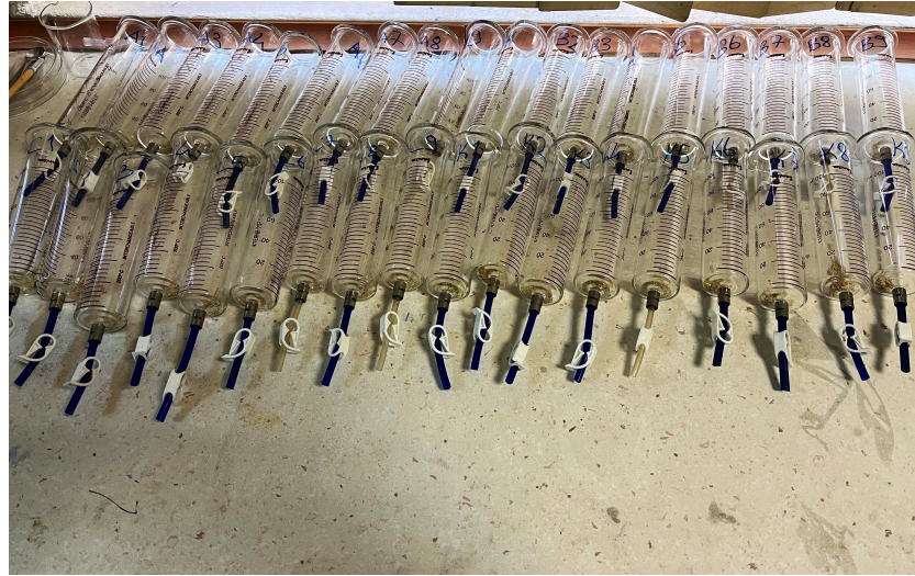
Şekil 2.7. Cam şırıngalar (Model Fortuna, Haberle Labortechnik, Almanya)
